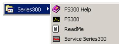
Das Programm **FS300** läuft vor der Freischaltung mit einem Key-Code nur als Simulation, ohne dass eine Verbindung zum Gerät besteht. Bevor Sie den R&S FS300 fernbedienen können, müssen Sie die Software freischalten. Das geschieht mit dem Service-Programm **Service Series300**.
