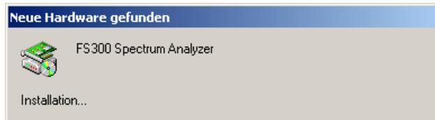
Sollte der R&S FS300 nicht automatisch erkannt werden, überprüfen Sie bitte, ob der USB-Master-Umschalter des R&S FS300 auf **AUTO** steht (↗ Bedienhandbuch R&S FS300, Kap. 6.3.4.3 Geräteschnittstellen konfigurieren).
